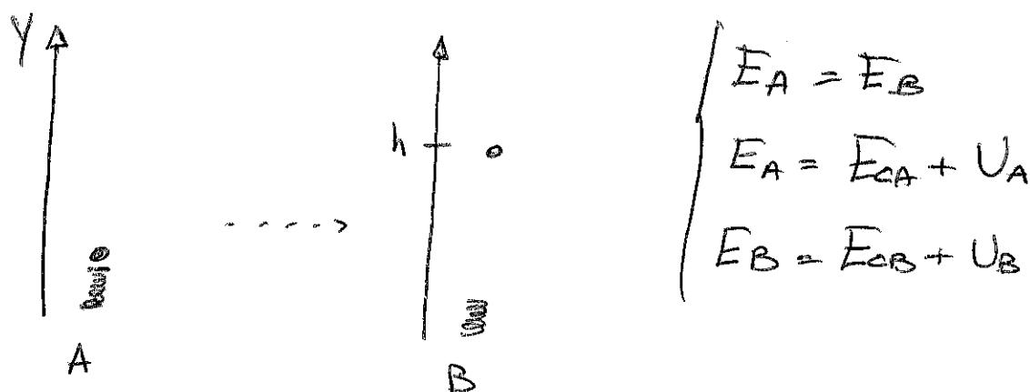
Vediamo nel caso più generico possibile, abbiamo 2 componenti dell'energia potenziale, la gravità e la molla.
