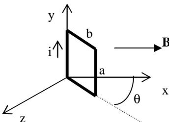
7) Un pezzo di filo di massa  $m=0.10$  Kg e lunghezza totale  $L=4$  m è usato per costruire una bobina quadrata di lato  $l=0.1$  m. La bobina è sospesa lungo un lato orizzontale e conduce  $i=3.4$  A. È posta in un campo magnetico verticale
