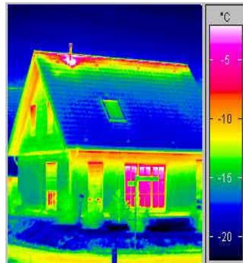
Nella figura di sinistra un esempio delle cause medie di dispersione del calore di un edificio. La figura di destra mostra l'immagine di una moderna. Le zone più calde sono quelle a maggiore dispersione energetica.
