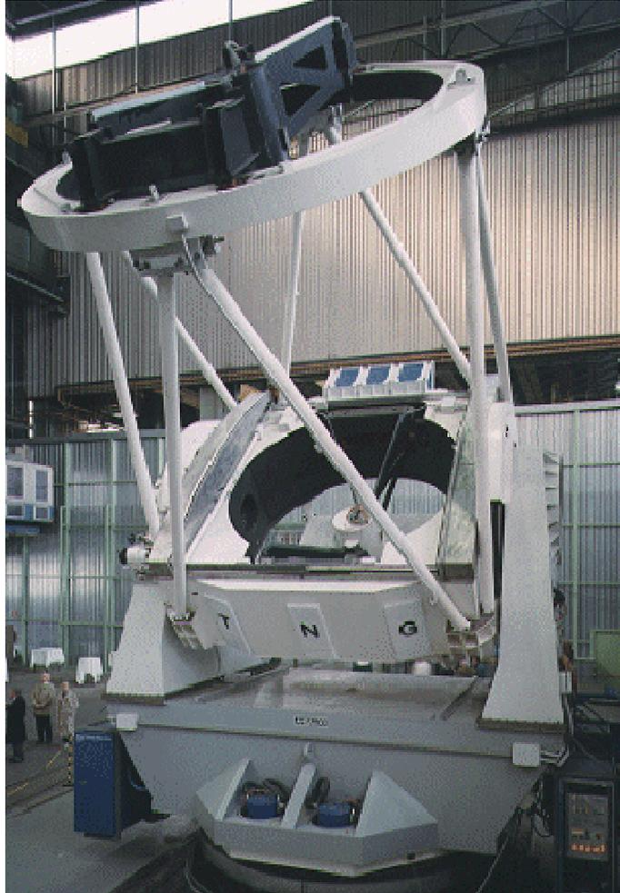
Figura 2.11 – Montatura altazimutale del Telescopio Nazionale Galileo (diametro: 3.58 metri)
