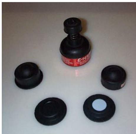
Figura 3 - Sistema di misura passivo ad elettreti
