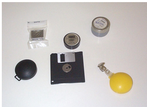
Figura 2 - Dispositivi a tracce per la misura della concentrazione di radon
