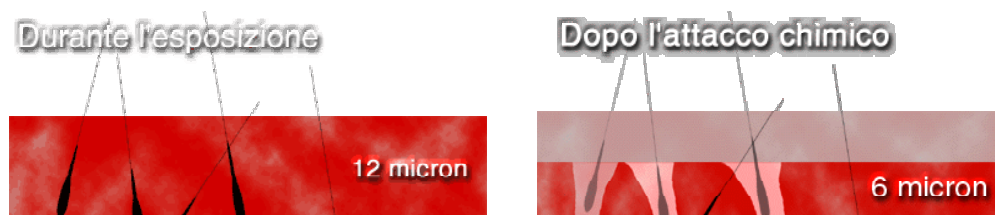
Figura 1 - Formazione e sviluppo delle tracce nucleari
