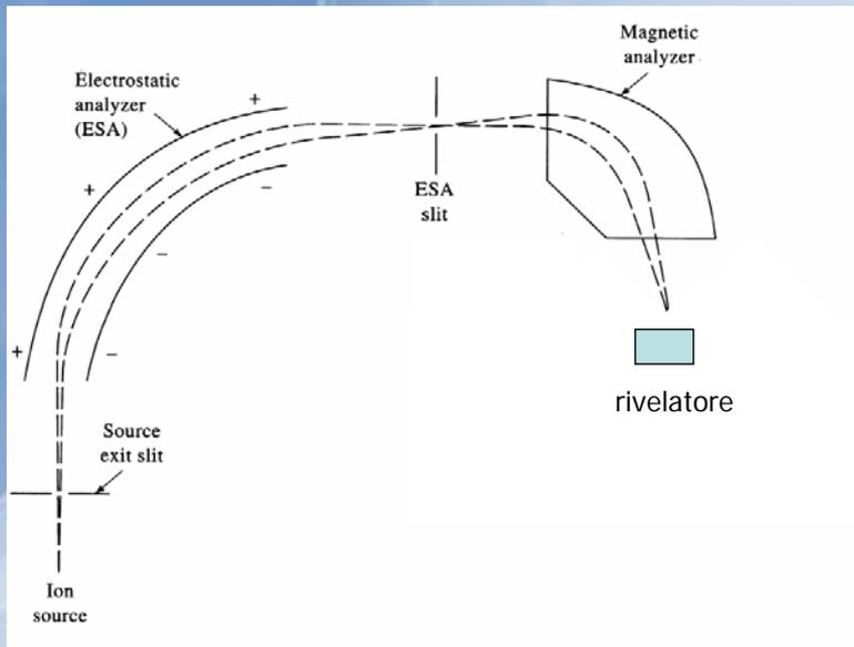
Con uno spettrometro dotato di doppio analizzatore si raggiungono risoluzioni in massa dell'ordine di 100000
