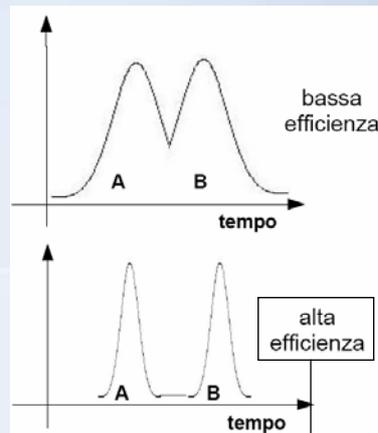
caratteristiche adatte per una successiva analisi spettrometrica
