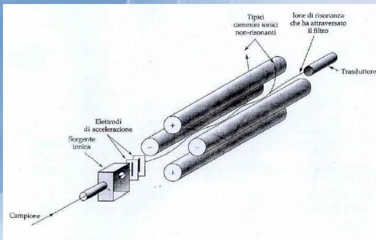
Questo tipo di analizzatore è di norma più compatto e ha costi più contenuti di quello formato dal doppio analizzatore.
