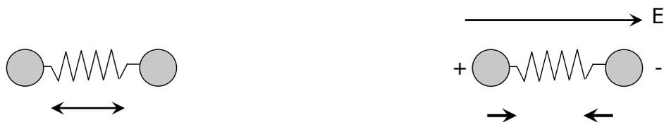
L'onda EM interagisce con la molecola grazie alla presenza del campo elettrico. Quindi, se una molecola non è polare il campo elettrico non riesce a cederle energia e a modificare il suo stato vibrazionale; di conseguenza non si osserva alcun assorbimento IR.
