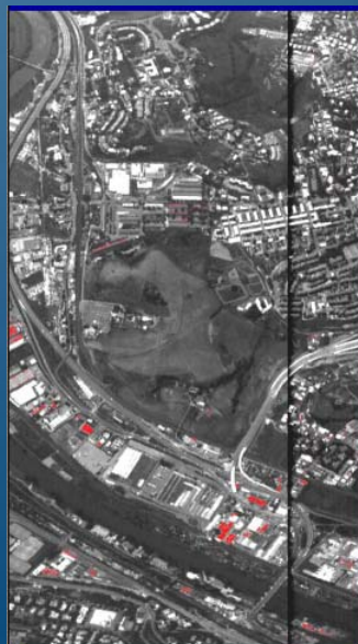
Immagine IR/ le zone rosse indicano la presenza di coperture di amianto
