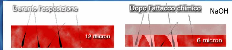
CR-39: permette di individuare il passaggio della radiazione ionizzante all'interno della zona di misura e NON fornisce indicazioni né sull'energia della radiazione stessa né sull'istante in cui la radiazione ha attraversato il materiale.
