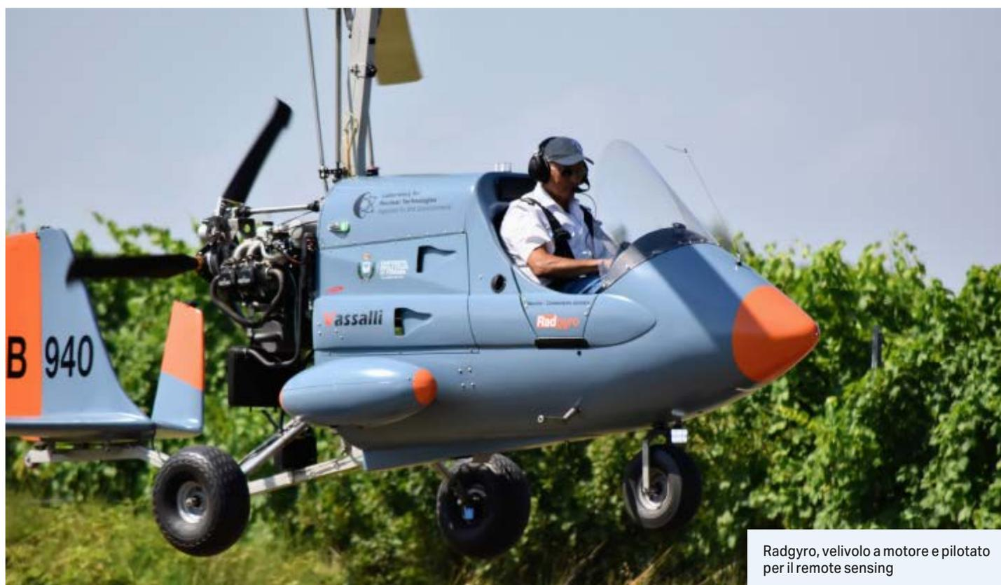
Radgyro, velivolo a motore e pilotato per il remote sensing
