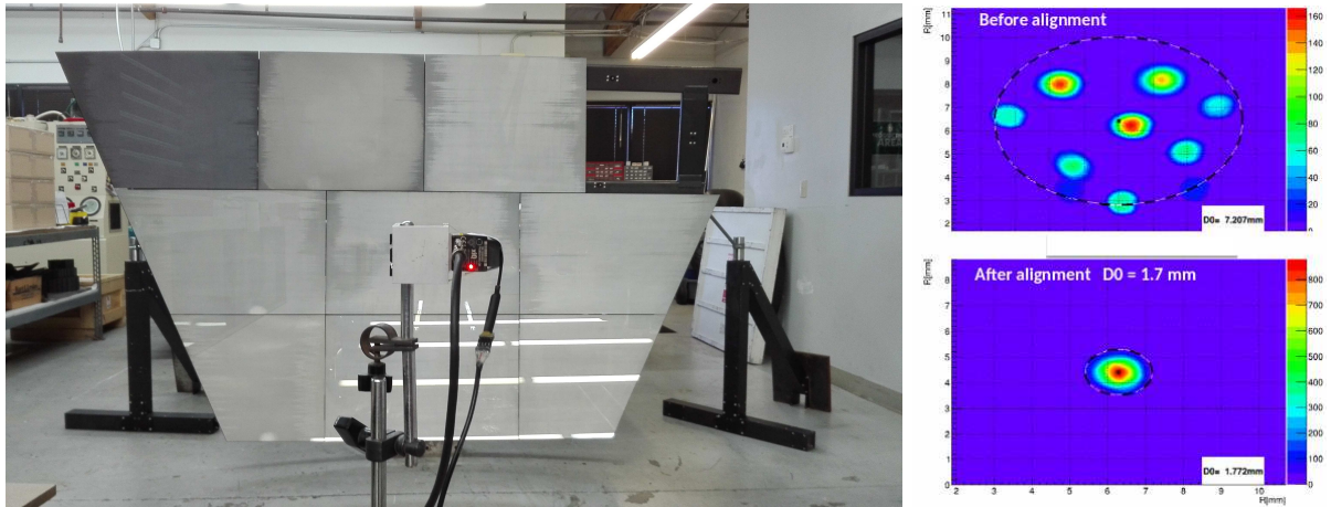
Figure 10: Valori del D_0 (snistra) e del raggio di curvatura (destra) misurati per gli specchi sferici.
