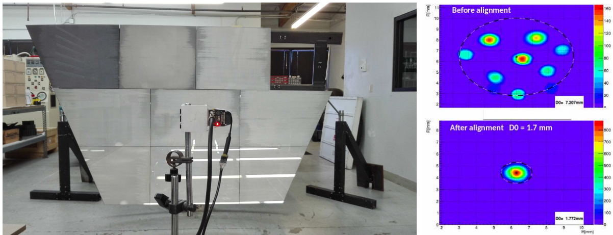
Figure 9: Valori del D_0 (snistra) e del raggio di curvatura (destra) misurati per gli specchi sferici.
