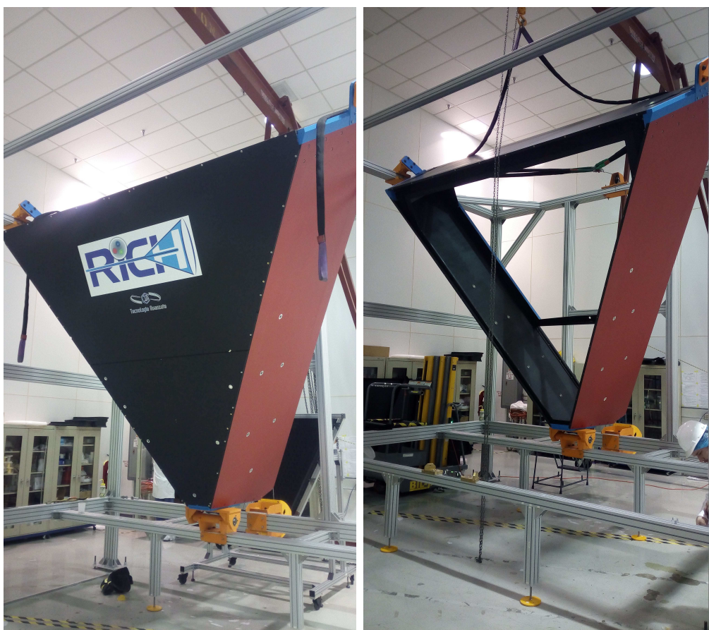
Figure 1: La struttura meccanica del RICH completamente assemblata in camera pulita al JLab (a sinistra) e dopo la rimozione dei pannelli di chiusura (a destra).
