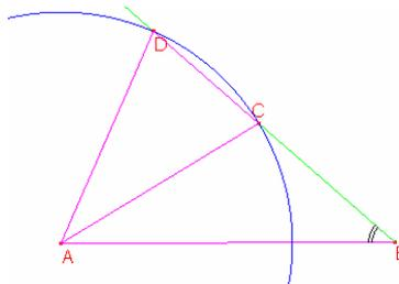
Disegniamo il triangolo  $ABC$  e prolunghiamo il lato  $BC$  nella semiretta  $Bc$ , puntiamo il compasso in  $A$  con apertura  $AC$  e disegniamo un arco che interseca  $Bc$  in un secondo punto  $D$ .
