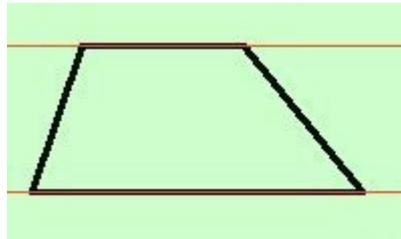
I due lati paralleli si chiamano **basi**; una è la **base maggiore**, l'altra la **base minore**. I due **lati obliqui**, non paralleli, vengono anche chiamati semplicemente **lati** del trapezio. La distanza fra le due basi è l'**altezza** del trapezio.
