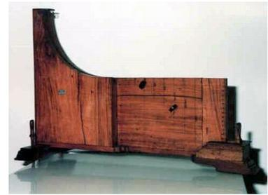
Manovrando il dispositivo di rilascio della biglia (vedi foto), essa percorre lo scivolo incrementando gradualmente la propria velocità. Quindi, non appena la biglia lascia lo scivolo con una certa velocità (con direzione parallela al suolo per costruzione), essa si troverà soggetta all'accelerazione di gravità: il piano di traiettoria risulta dunque perpendicolare al suolo. Ora si
