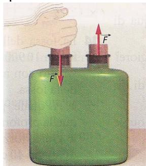
Il recipiente della figura è completamente pieno di olio ed è chiuso mediante due tappi uguali. Se diamo un colpo secco a uno dei tappi, l'altro salta.
