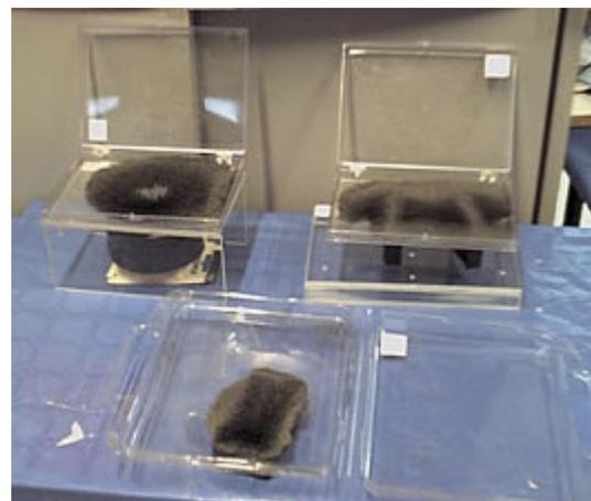
Della limatura di ferro è disposta disordinatamente su un supporto di plastica. Sotto il supporto si dispone un magnete. La limatura di ferro si aggrega formando dei
