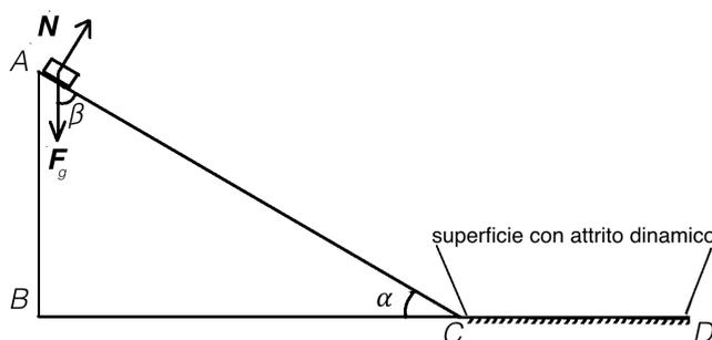
**Figura 3.9** All'esempio presentato in Fig. 3.8 viene aggiunto un piano orizzontale, sul quale tra corpo e superficie c'è attrito dinamico.
