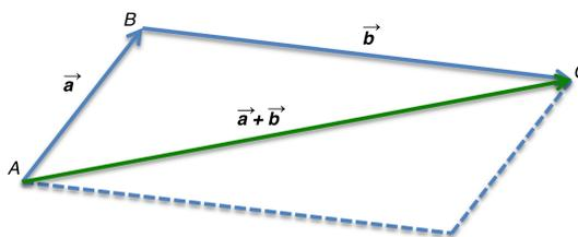
La differenza tra due vettori si ottiene dalla somma del secondo meno l'opposto del primo, sempre secondo la regola del parallelogramma. In Fig. 3.2 si riporta tale operazione sui vettori, con la notazione per la scrittura sul grafico, e la notazione a stampa nella didascalia e nel testo.
