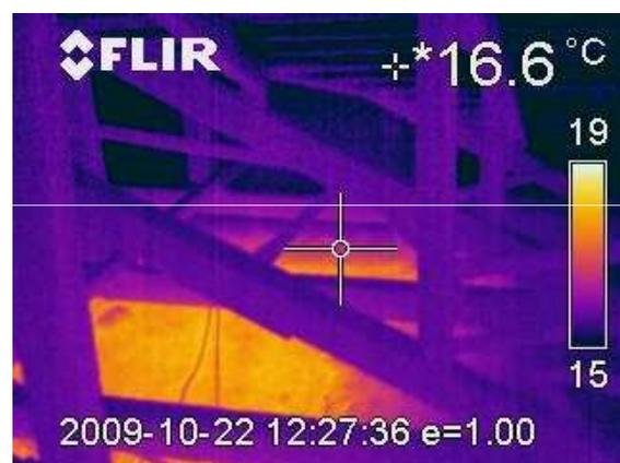
Termogramma in trasmissione, la termocamera si trova dalla parte rispetto a dove si scalda.
