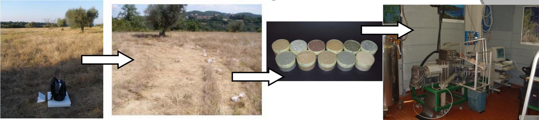
Assumendo che il sito naturale sia **omogeneo** misuriamo lo spettro gamma **N** con lo **ZaNaI\_03** ed il contenuto di radioattività **C** in campioni con **HPGe**:
