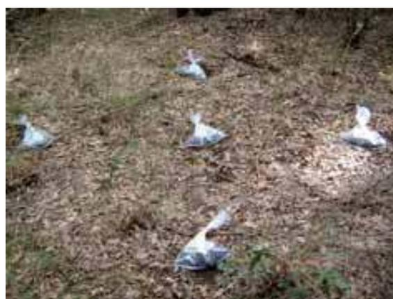
Fig. 5 - Esempio di disposizione dei prelievi di campioni di suolo rispetto al punto centrale nel quale è stata realizzata la misura di spettroscopia gamma in situ.
