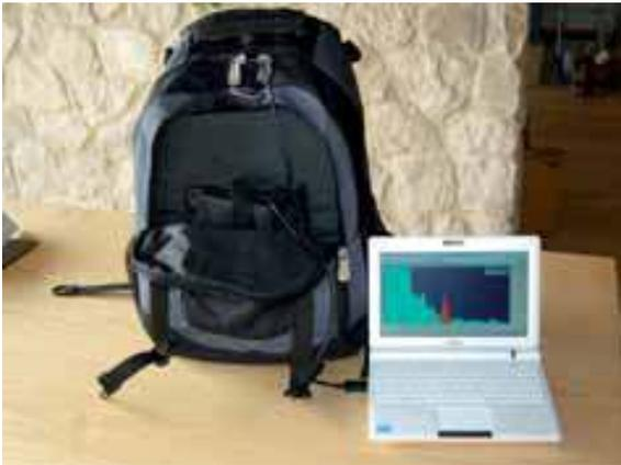
Fig. 1 - Spettrometro gamma portatile utilizzato per misurare la presenza di radioisotopi in situ.
