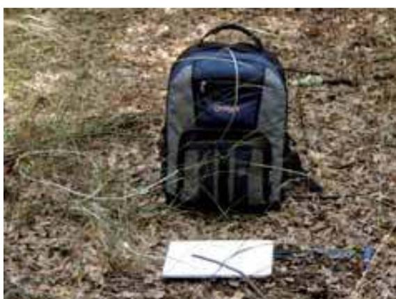
Fig. 4 - Esempio di misura di spettroscopia gamma in situ con strumento appoggiato a terra
