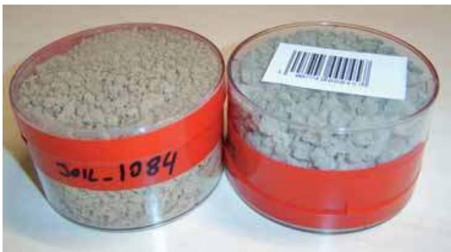
Fig. 6 - Esempio di campioni di suolo pronti per essere analizzati dall'MCA\_Rad.
