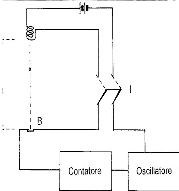
Precisione su intervalli di tempo con un oscillatore (impulsi/s), un contatore (ris. 1 impulso).
