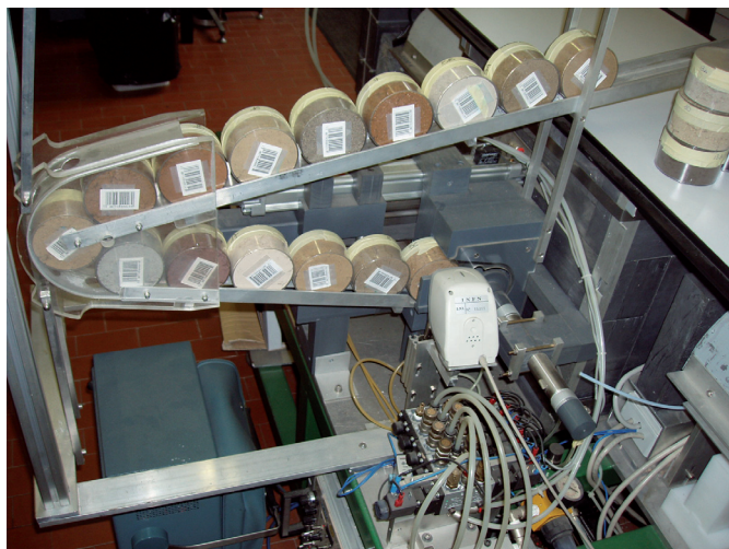
Fig. 2 – Il detector al germanio MCA_Rad operativo presso i Laboratori Nazionali di Legnaro (INFN).
