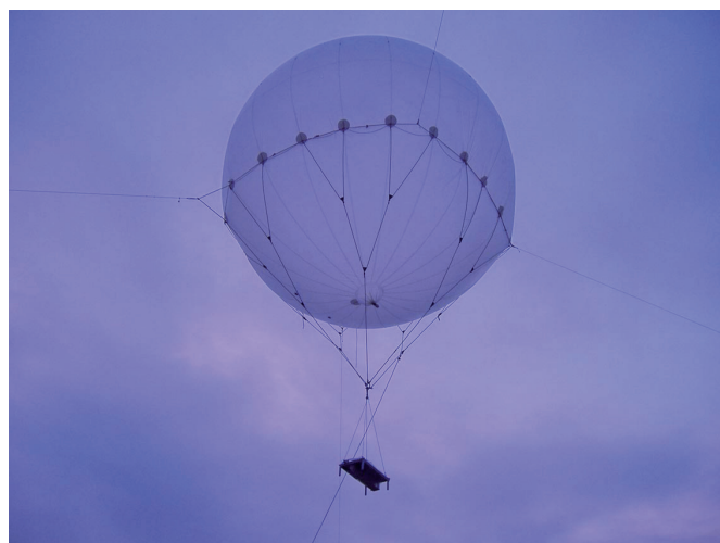
Fig. 1 – Il pallone ad elio impiegato per le misure di spettroscopia gamma presso i Laboratori Nazionali di Legnaro (INFN).
