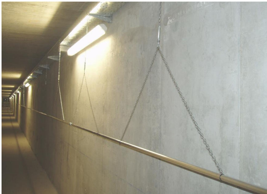
Figura 3.1: Foto della guida d'onda acustica nel tunnel del laboratorio LARIX.
