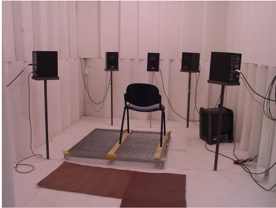
Figura 4.4: Il sistema di diffusione 5.1 nella camera anecoica.
