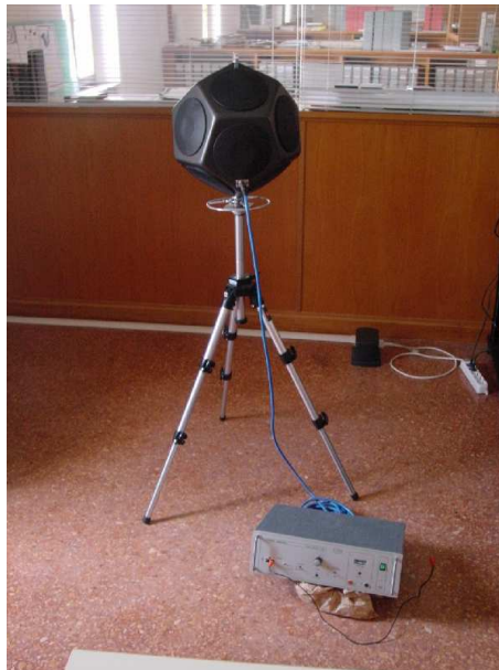
Figura 2.12: Sorgente omnidirezionale dodecaedrica con amplificatore di potenza.
