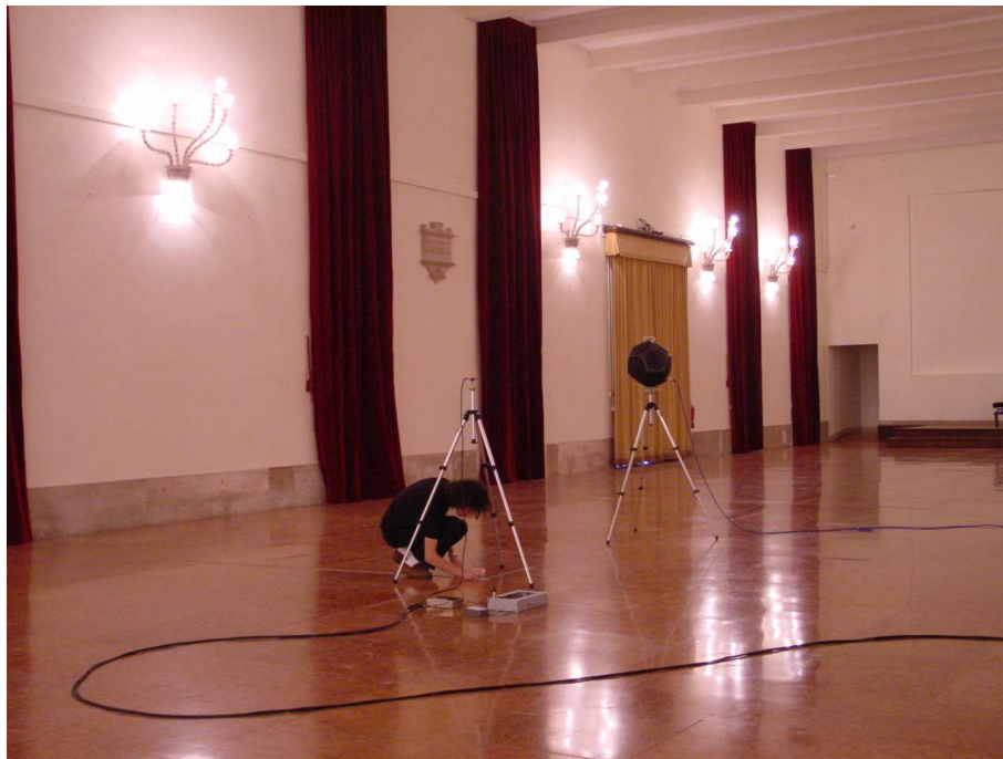
Figura 2.17: La Sala Carnelutti al momento della misura: sono visibili la sorgente omnidirezionale e la sonda intensimetrica.
