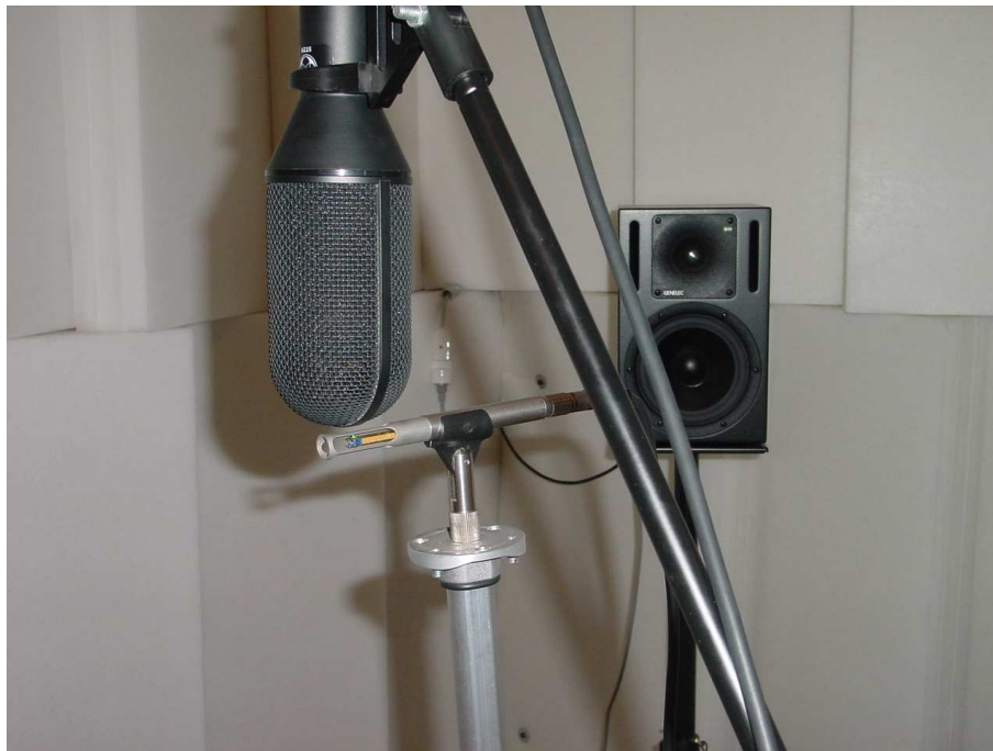
Figura 3.8: Il confronto tra la sonda Microflown e il microfono Soundfield è stato effettuato in camera anecoica disponendo i due sensori in configurazione coincidente.
