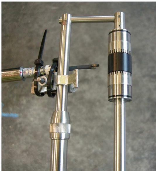
Figura 3 – Particolare delle sonde intensimetriche assiali p-p (destra) e p-v (sinistra)
